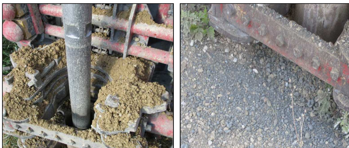
Fig. 13. Alluvions récentes (gauche) et marnes calcaires (droite) lors du forage
